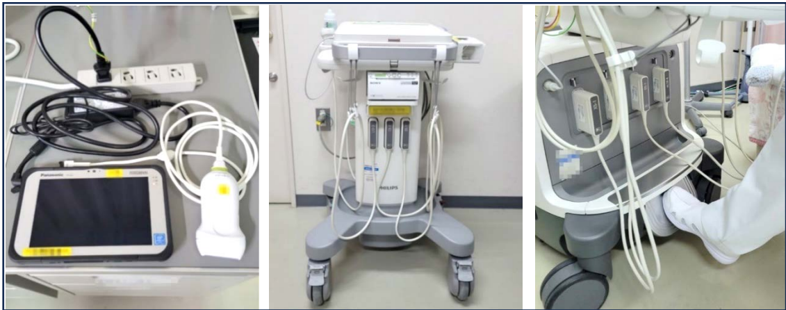
図5 超音波診断装置のバッテリー充電とキャスターロック
